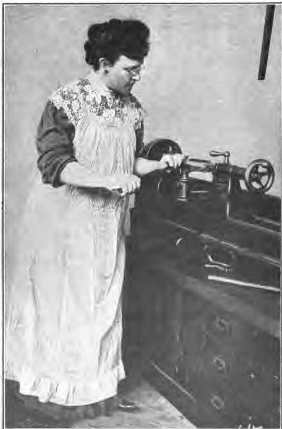
Fig. 29. Using the Skew Chisel.
